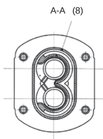
图示为左旋泵的剖面
